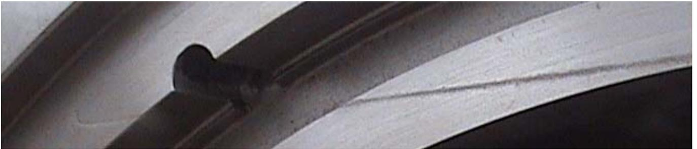
El diámetro interior de la superficie de sellado es de 640 mm, y el diámetro exterior es de 677 mm (ver pág. 4). La altura hacia una segunda superficie de sellado (con diámetros de 713 y 770 mm, respectivamente) debe de ser mantenida, pero en caso que debido al proceso de maquinado esta altura resulte estar fuera de la tolerancia, se tendría que maquinar también la segunda superficie ....
